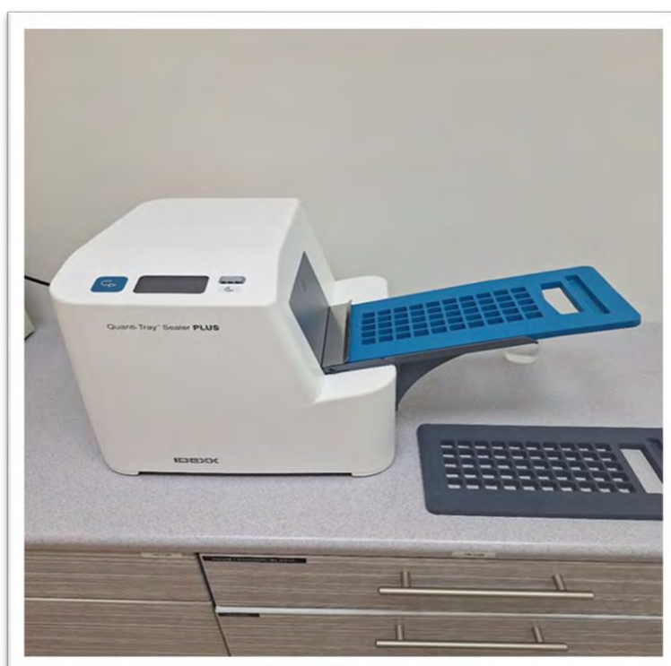
Zgrzewarka Idexx Quanti-Tray Sealer Plus do wykonywania badań mikrobiologicznych próbek wody
