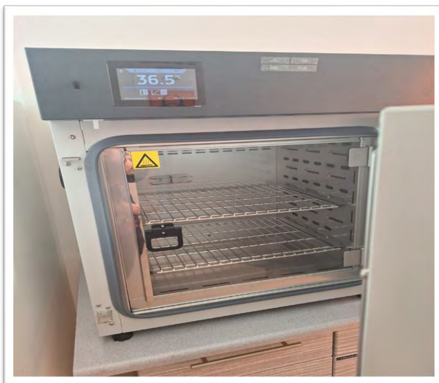
Cieplarka do wykonywania badań mikrobiologicznych próbek wody
