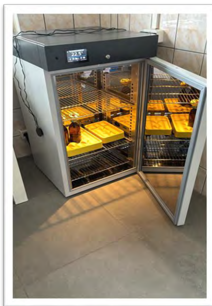
Szafa termostatyczna do wykonywania badań BZT5 w próbkach ścieku
